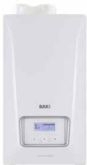
La caldaia a condensazione da 28 kW è caratterizzata da un **campo di modulazione 1:10** che determina una maggiore efficienza data da minori accensioni e spegnimenti: con un rapporto di modulazione elevato la **riduzione dei continui cicli di on/off** comporta una significativa riduzione dei consumi (dell'8-10%), una pari riduzione delle emissioni inquinanti e una **maggiore silenziosità in ambiente per l'utente**.
