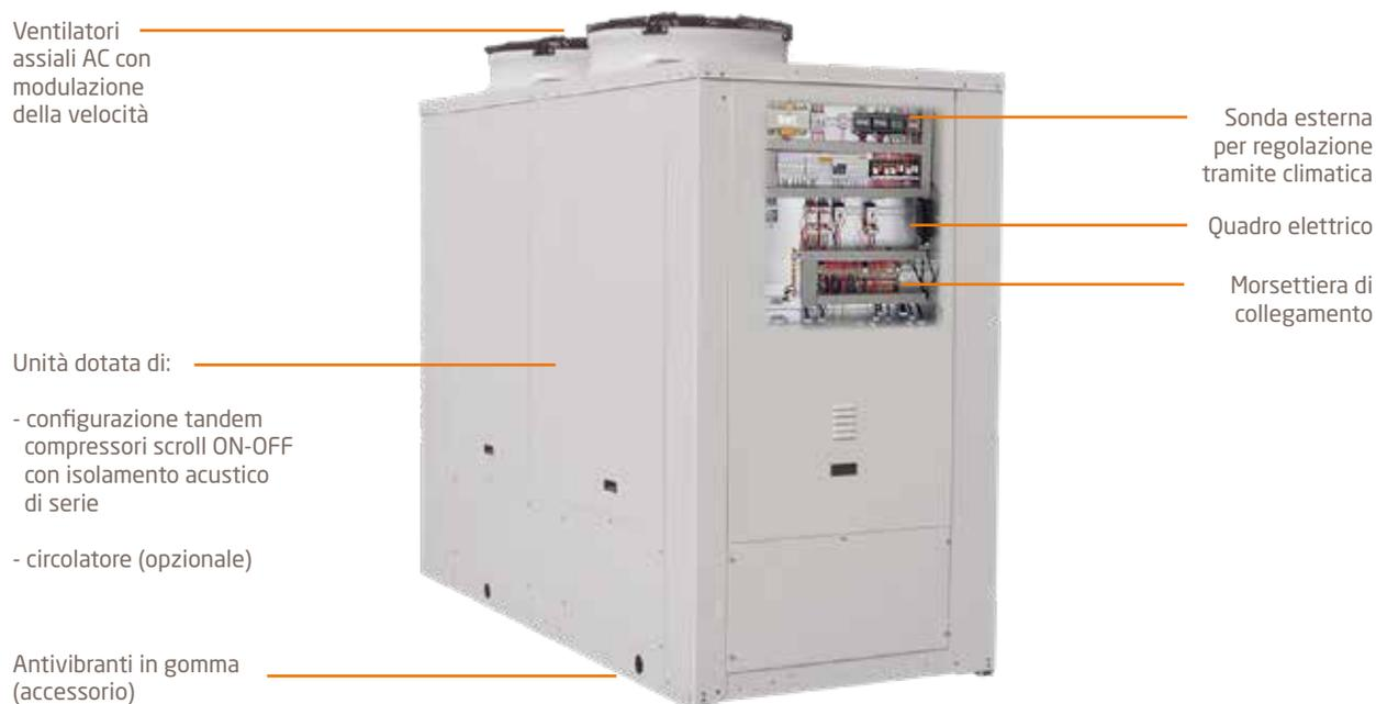
**Struttura:** di tipo autoportante, realizzata in lamiera zincata con un'ulteriore protezione ottenuta tramite verniciatura a polveri poliestere. I pannelli, facilmente rimovibili, permettono l'accesso all'interno dell'unità per le operazioni di manutenzione e riparazione.
