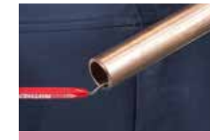
3. Utilizzare uno sbavatore a stilo sui bordi del tubo interno
