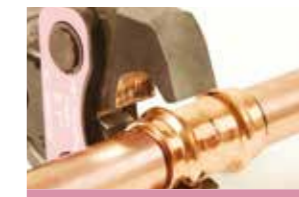
9. Allineare le ganasce perpendicolarmente con il raccordo
