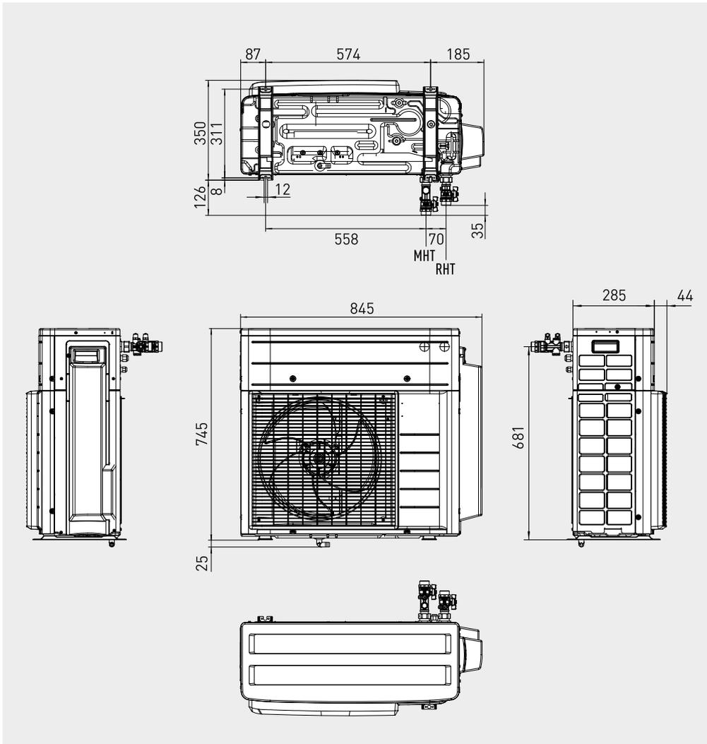
Attacchi pompa di calore monoblocco
