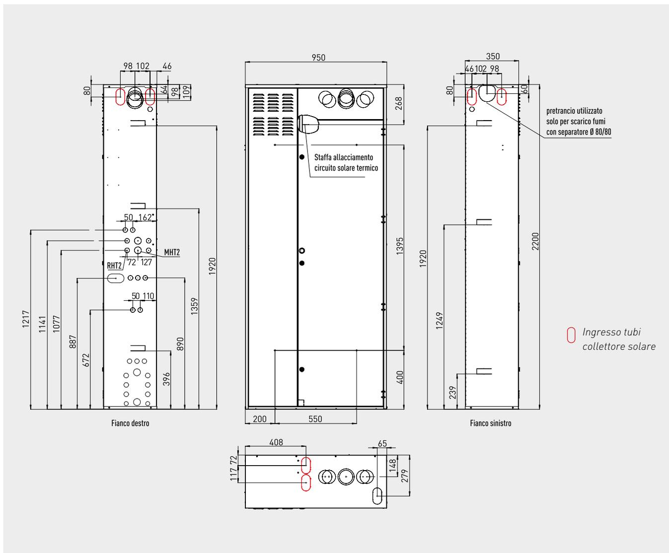
**Attenzione:** gli allacciamenti alla pompa di calore (MHT2 e RHT2) possono essere effettuati unicamente sul lato destro del telaio da incasso.
