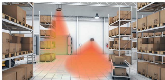
Fase2 - attivazione degli aerotermi per raggiungere il livello di temperatura impostato dall'utente
